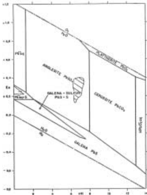
FIG. 8. Relacions d'estabilitat entre els compostos del plom en les aigües naturals a 25 °C i 1 atmosfera de pressió
