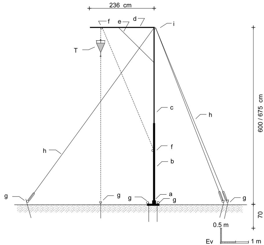
**Figura 1.** Estructura del modelo diseñado (Datos técnicos en Cuadro I). a) Pie de anclaje. b) Pie derecho, primer tramo. c) Pie derecho, segundo tramo. d) Brazo horizontal. e) Varilla escuadra. f) Poleas móviles. g) Clavos de anclaje. h) Juego de vientos. i) Anilla con tuerca. T) Trampa para *Z. pyrina*.
