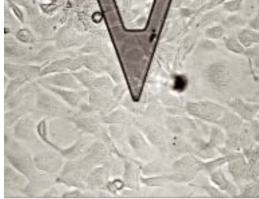
FIGURA 3. Microflexor triangular en contacte amb la superfície d'una cèl·lula epitelial bronquial humana (BEAS-2B) en cultiu. Imatge obtinguda amb un microscopi òptic invertit amb camp brillant.
