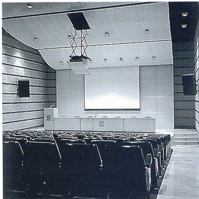
Figura 10: Sala de conferències. Auditori del Laboratori General d'Assaig i Investigacions. Cerdanyola del Vallès. Arquitecte: J.M. Jordà-CAST. V = 623 \text{ m}^3 , N = 126 seients. TRMID = 1,08 s
