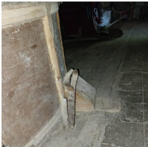
FIGURA 9. Sistema aixecador de les moles. Maneta.
