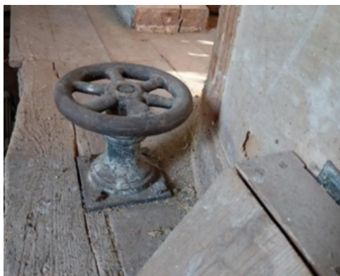
FIGURA 10. Sistema regulador d'alçada de les moles. Rodet.
