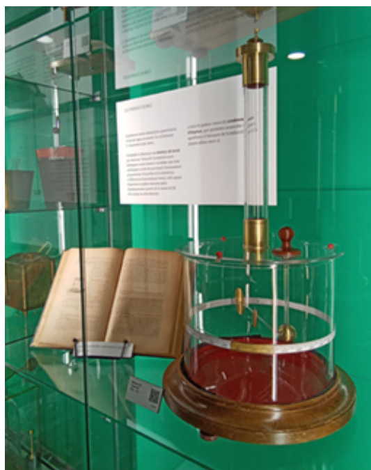
FIGURA 1. La balança petita de Coulomb a la vitrina, després de la darrera restauració. FONT: Elaboració pròpia.
